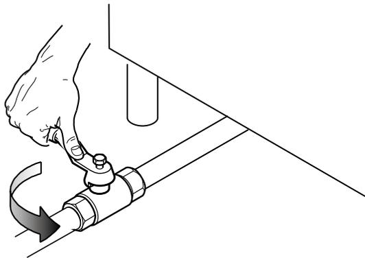
4. Pulire le condutture di allacciamento da polvere, sporcizia, materiali estranei che potrebbero ostruire l'alimentazione. La linea di alimentazione del gas deve assicurare la portata necessaria al pieno funzionamento di tutte le apparecchiature collegate alla rete stessa.
